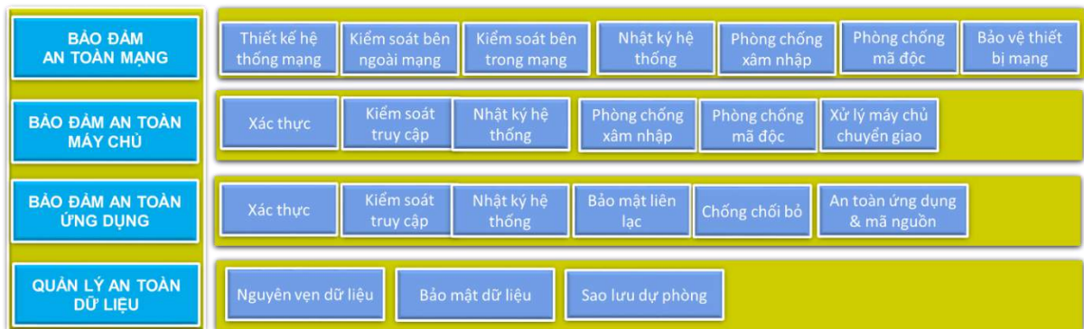
Hình vẽ 11: Mô hình yêu cầu về kỹ thuật đảm bảo an toàn thông tin
